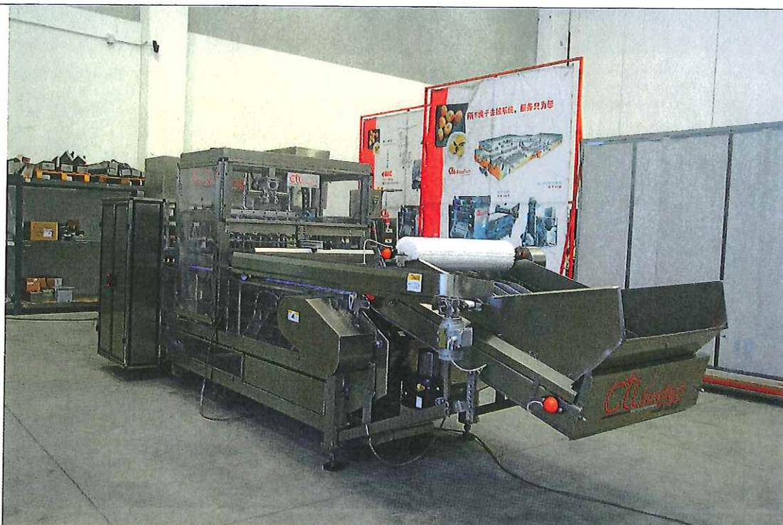
Le soluzioni di Mitsubishi Electric si integrano perfettamente nelle macchine CTI FoodTech, garantendo una migliore performance di denocciolatura rispetto a qualsiasi altra macchina. In figura, il sistema Coring Multifruit che nasce per lavorare le pesche ma può lavorare anche altri frutti, per esempio mele e pere.
